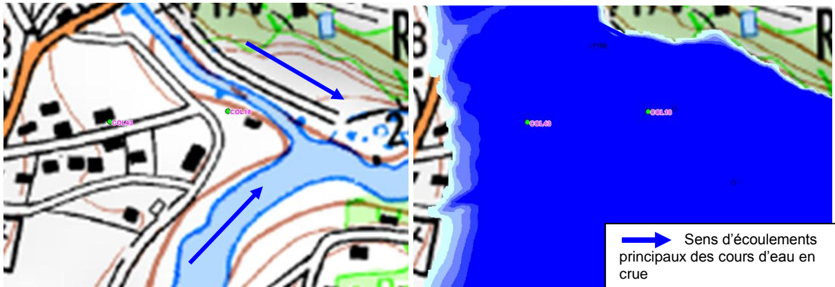
Figure 61 : Illustration de l'aléa inondation de référence modélisé par Hydratec en 2015
