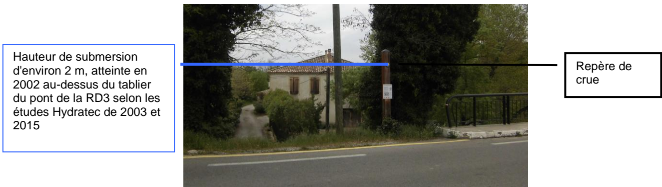
Figure 29 : Illustration de la hauteur de submersion observée au droit de la propriété lors de la crue de septembre 2002
