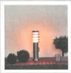
Un éclairage de sécurité secouru (autonomie de 6 heures) doit baliser les cheminements et les points de regroupement. Le balisage peut être effectué avec des bornes solaires qui doivent être d'une puissance minimum de 60 lumens et espacées de 30 m.
