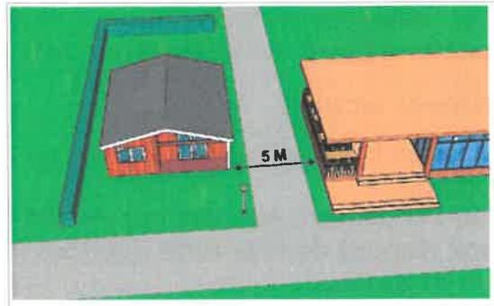
*Afin de prévenir la propagation d'un incendie, les hébergements devront être espacés entre eux d'une distance minimale de 4 m, de façade principale à façade principale, y compris terrasses couvertes, annexes en matériaux combustibles.*
