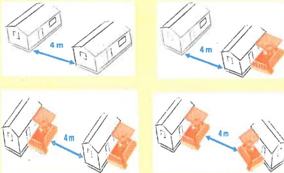
*Afin de prévenir la propagation d'un incendie, lors du changement d'hébergement, l'installation sera à une distance minimale de 2 m des hébergements voisins, de façade principale à façade principale y compris terrasses couvertes, annexes en matériaux combustibles.*
