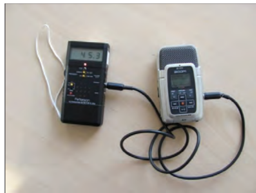
PETTERSSON D240X couplé à un enregistreur numérique
