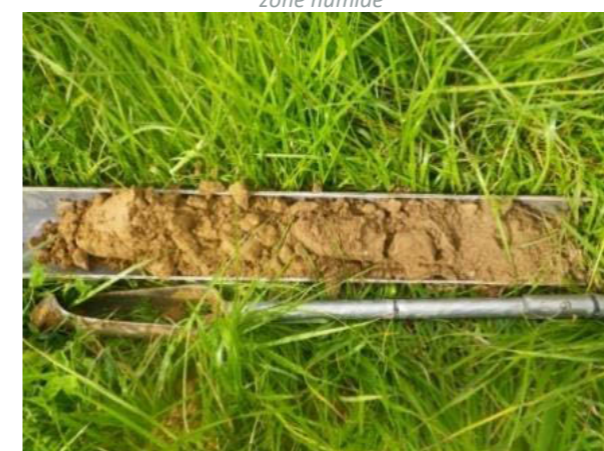
Sondage 3 en pelouse à Brachypode de Phénicie : sol non caractéristique de zone humide
