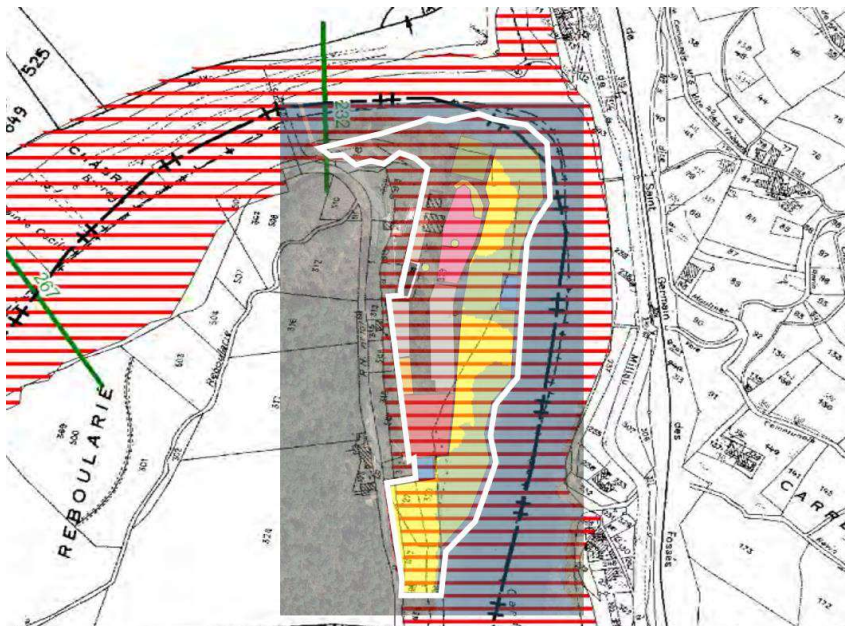
Figure 6 : Installation de chantier et cartographie de l'Aléa inondation du PPRI
