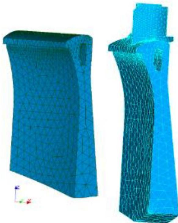
Figure 68 : Zoom sur le maillage des plots BC et DE avec la cabine en crête [Réf 5]
