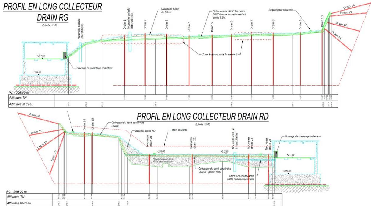
Figure 16 : Implantation des dispositifs d'auscultation (profils en long)
