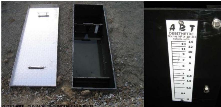
Figure 40 : Photo de l'ouvrage de comptage avec échancre de 1/8 (mesure allant de 0 à 14 m3/h) (Source : ABT)
