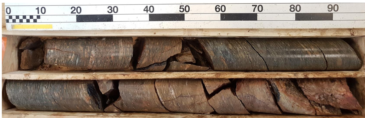
Figure 36 : Gneiss MW avec des passées HW (SC7 de 2,00 à 4,00 m/TN)
