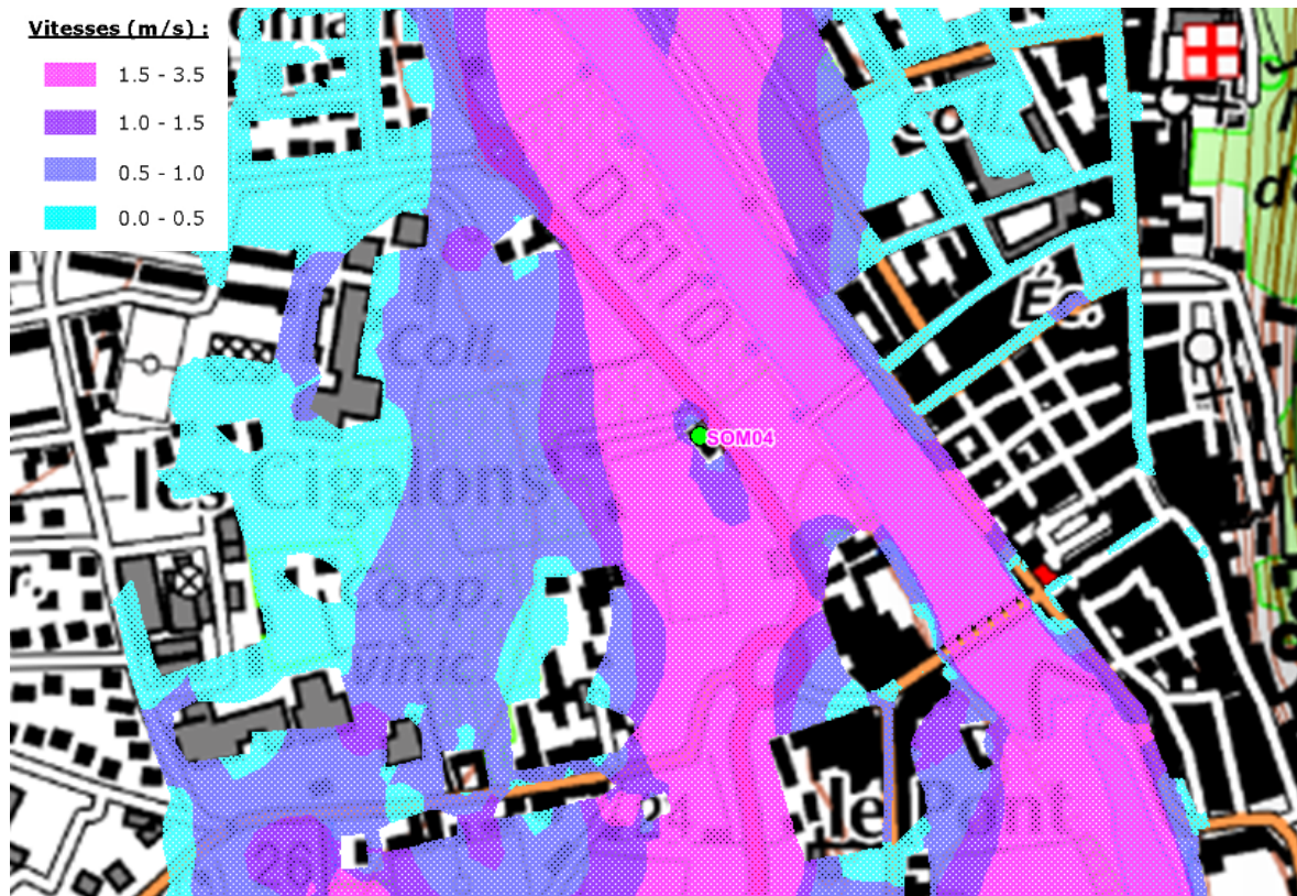
Figure 14 : Carte des vitesses modélisées à Sommières lors de la crue de septembre 2002 (source : CETE, 2005)
