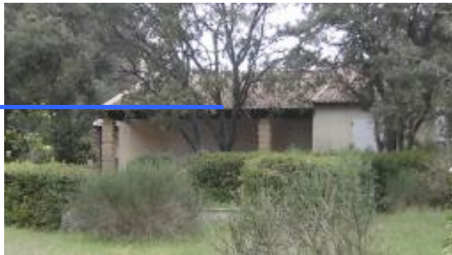
Figure 24 : Illustration de la hauteur de submersion observée au droit de la propriété lors de la crue de septembre 2002
