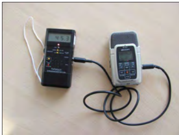
PETTERSSON D240X couplé à un enregistreur numérique
