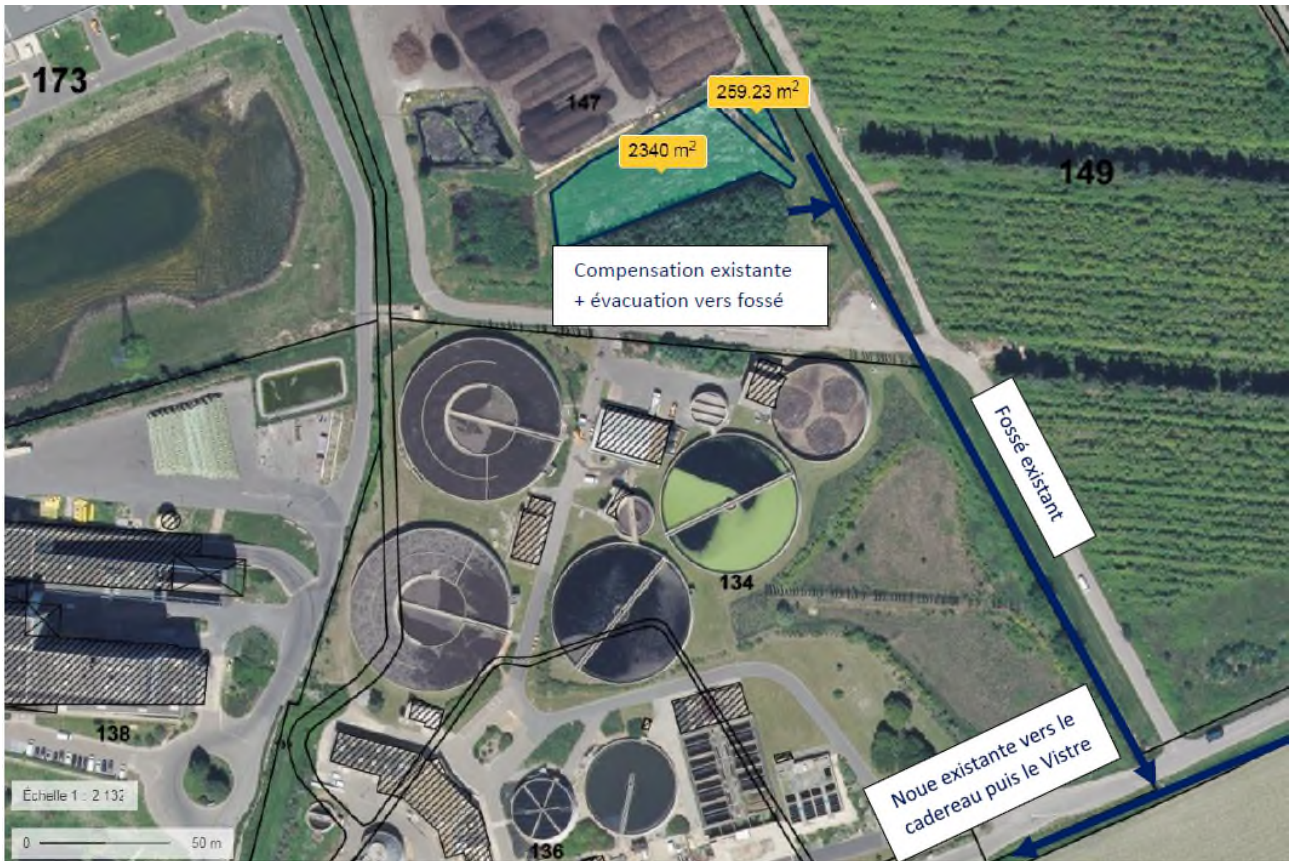
Figure 16 - Localisation du volume de compensation pour la PFC dans la système hydrologique existant
