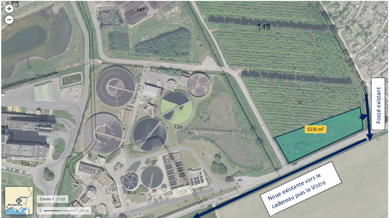
Figure 8: Intégration du volume de compensation de la station d'épuration dans le système hydrologique existant
