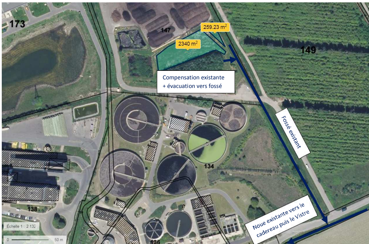
Figure 9: Localisation et intégration dans le système hydrologique existant du volume de compensation de la plateforme de compostage
