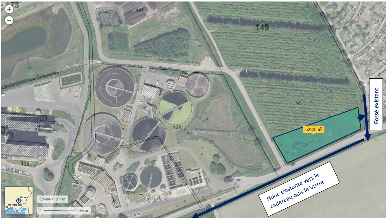
Figure 8: Intégration du volume de compensation de la station d'épuration dans le système hydrologique existant
