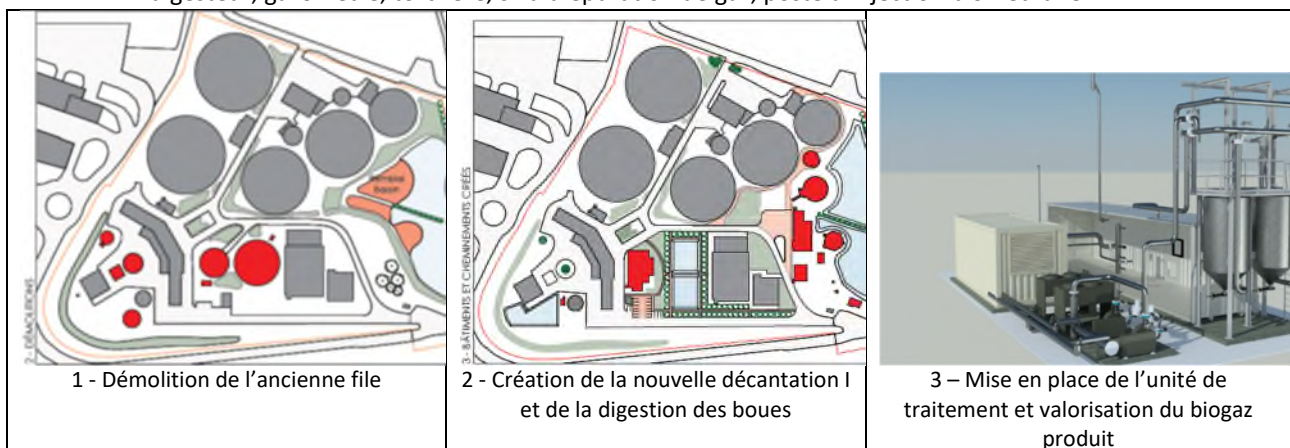
Figure 17 – Travaux menés sur le STEU
